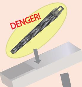
燃料体は、ジルコニウムのさや管に、使用前のペレットの状態で放射能が封入されているので、そのまま壊さずに保管することが、最も安全性が高いと考えられます。
